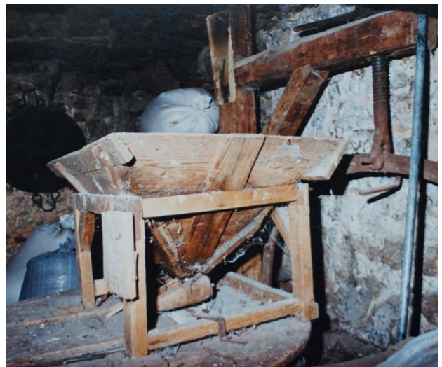
7. Αλεστικός μηχανισμός / The hopper and the crane
