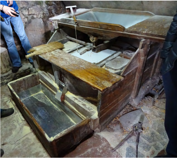
9. Ο αλεστικός μηχανισμός του νερόμυλου που εξακολουθεί να εργάζεται στη Μυρτιά / The grinding mechanism of the watermill that still works in Myrtia
